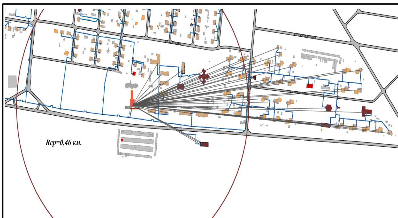
Рисунок 2.5.2 – РЭТС Котельной «Дорожник»
