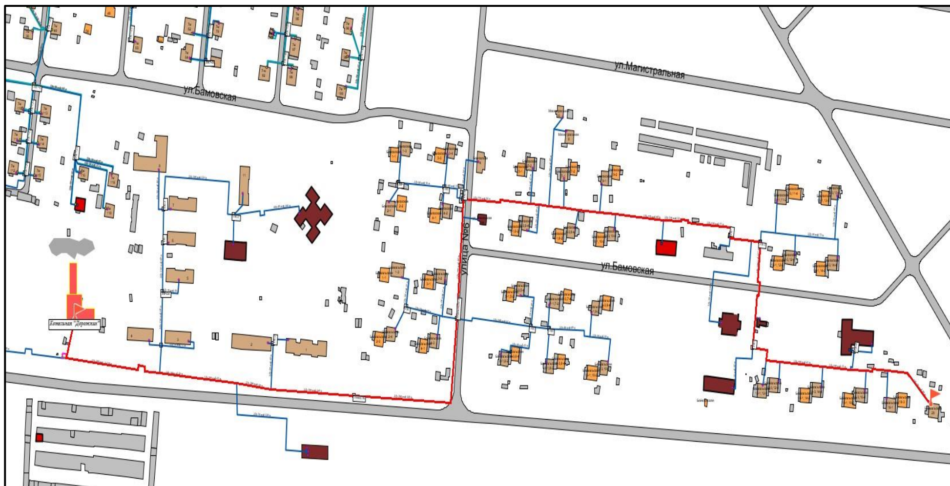
Рисунок 1.3.8.4 – Путь для пьезографика: Котельная «Дорожник» – Байкальская, 20
